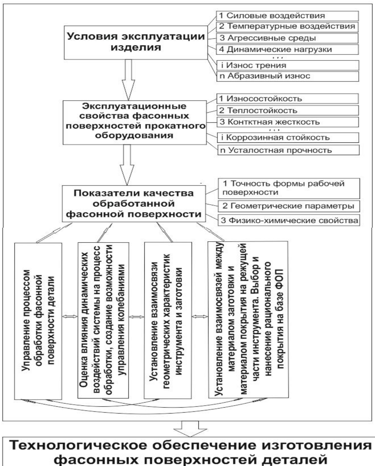
Рис. 2. Структурная схема процесса обеспечения качества фасонных поверхностей деталей прокатного оборудования
