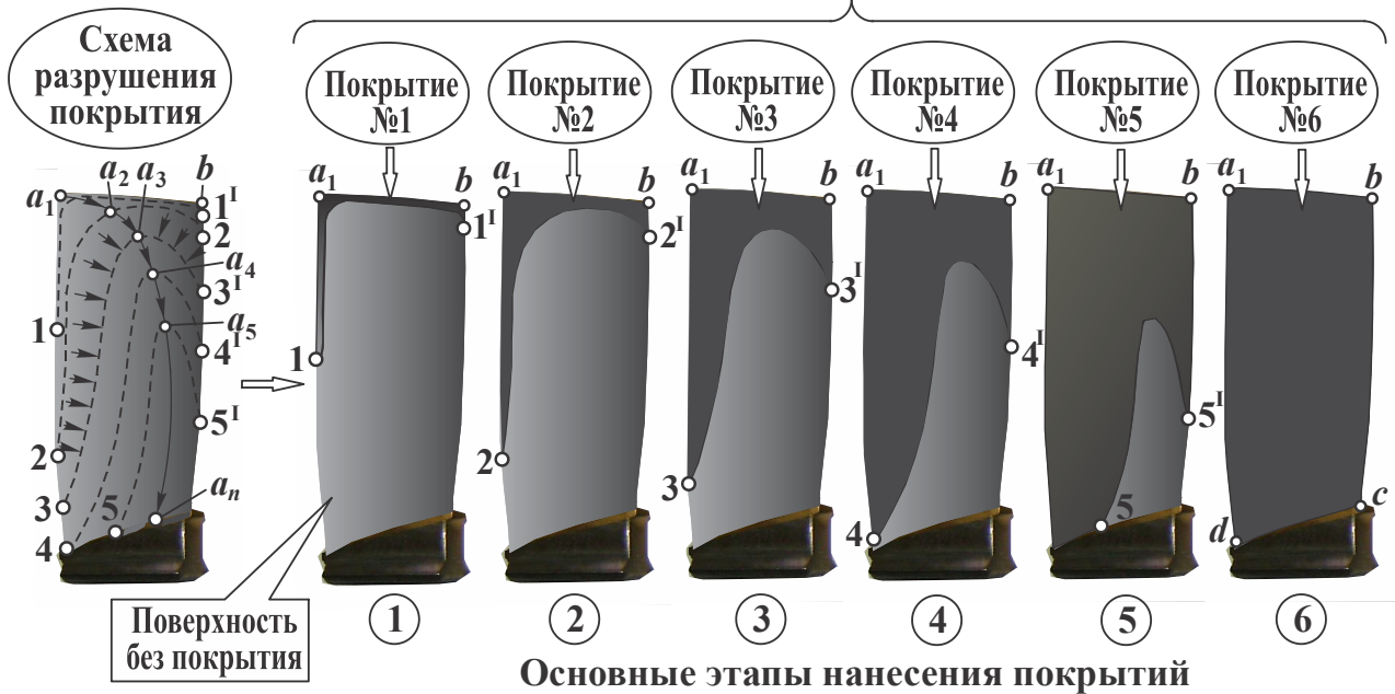
Рис. 4. Схема формирования многослойного функционально-ориентированного покрытия
