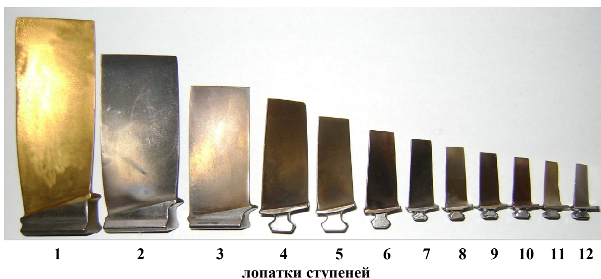
Рис. 1. Общий вид лопаток компрессора ГТД модели ТВ3-117
