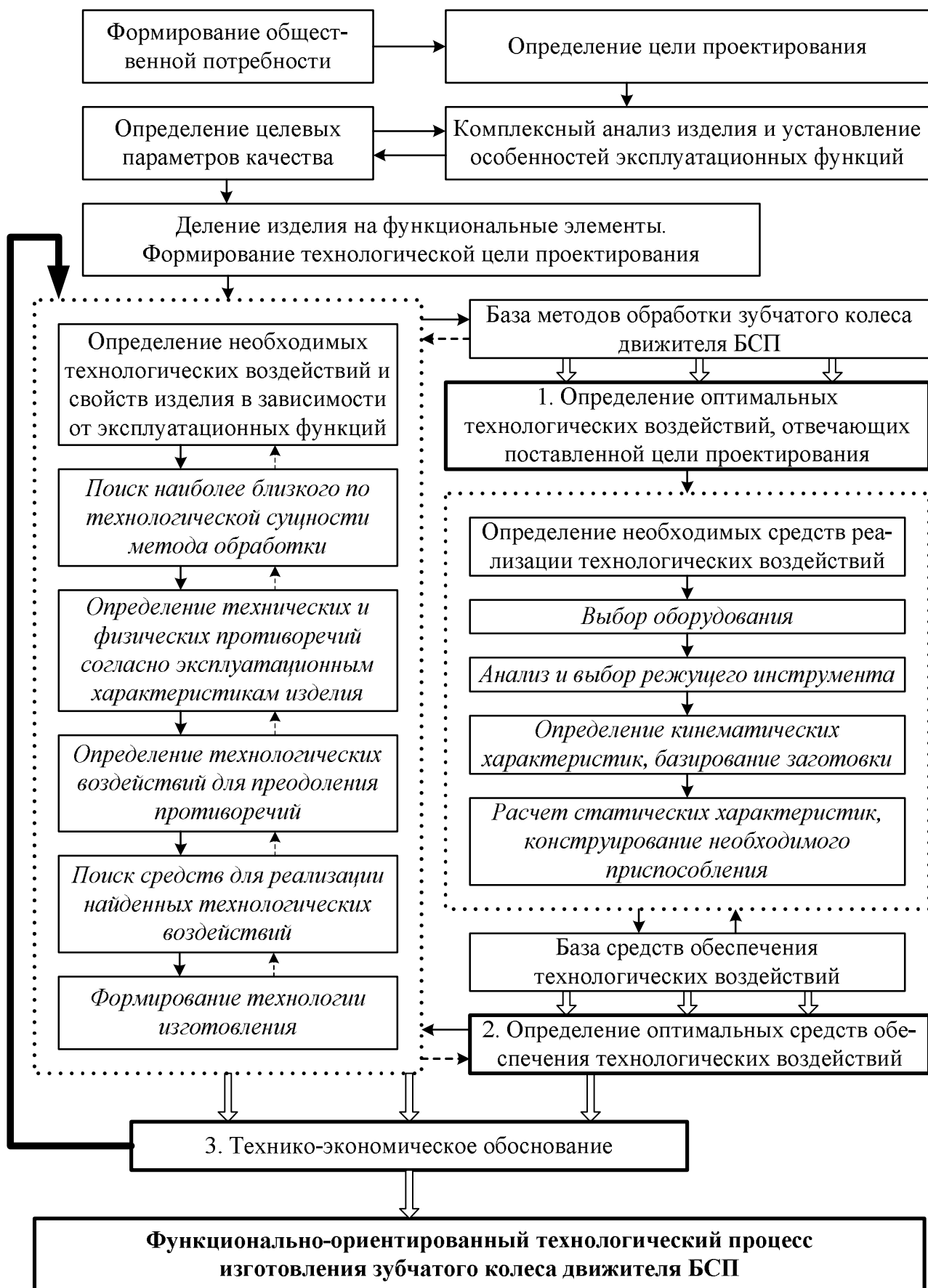
Рис. 1. Схема проектирования технологического процесса изготовления зубчатого колеса двигателя БСП
